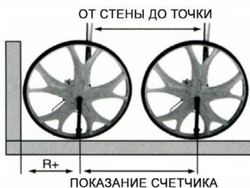
Если необходимо измерить расстояние от стенки до стенки – установите колесо к одной из стенок и двигайтесь к другой. По достижении второй стенки считайте показания и прибавьте к ним диаметр колеса (32 см). Во избежание получения неправильных результатов катите колесо по прямой линии, стараясь избегать углублений и бугров.
