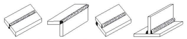
Стыковое соединение Угловое соединение Нахлёсточное соединение Т-образное соединение
